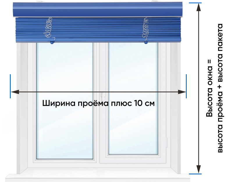
Монтаж над проёмом окна
