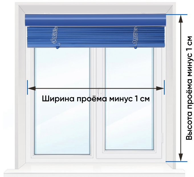
Монтаж в проём окна
